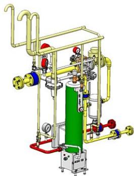
Испарительные установки СИНТЭК-И в серийном и индивидуальном исполнении, производительностью от 15 до 28 500кг/ч (при рабочем давлении 1.6 бар). В установку входит технологическое оборудование: испаритель, фильтр, запорно-предохранительная арматура, манометры, регулятор давления, отсекающий жидкой фазы (конденсатор-сборник). Испарительные установки СИНТЭК могут быть укомплектованы испарителями как прямого горения (автономными), электрическими или жидкостными.
