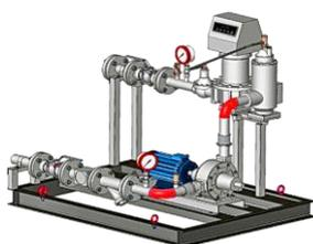
Насосные установки СИНТЭК-Н выпускаются производительностью от 30 до 500 л/мин (при рабочем давлении 10 бар). Установки комплектуются следующими типами насосов: открыто вихревыми с лопастями или самовсасывающими шибберными. Компрессорные установки СИНТЭК так же комплектуются электродвигателем, фильтром, предохранительным клапаном и сепаратором.
